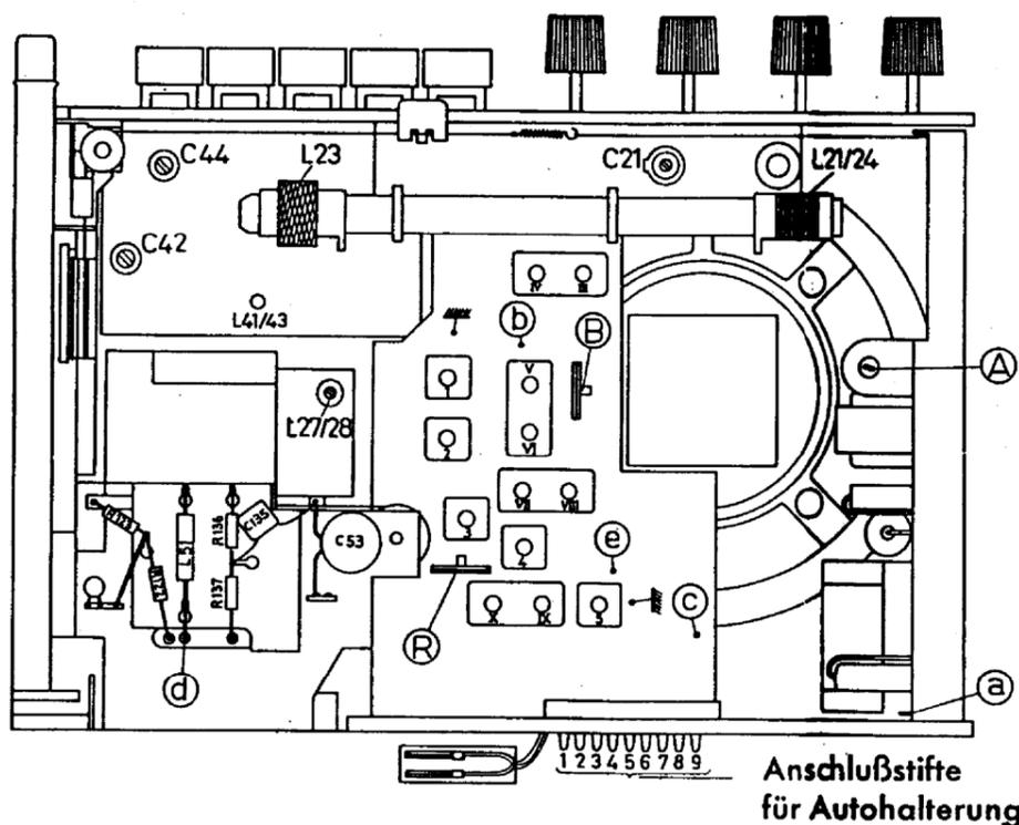
Führungsbuchse für Antennenumschaltung bei Autobetrieb
